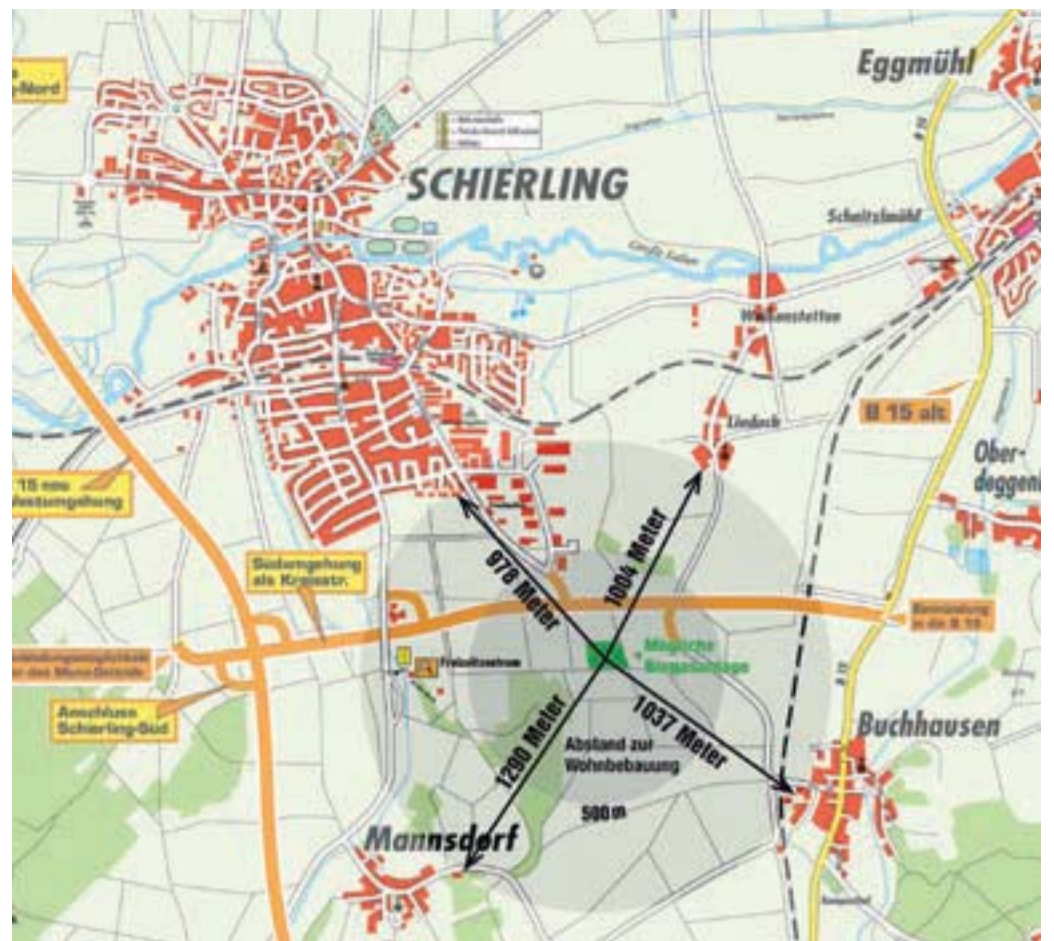
Möglicher Standort einer Biogasanlage - nah an der Straße, weit weg von Wohngebieten
