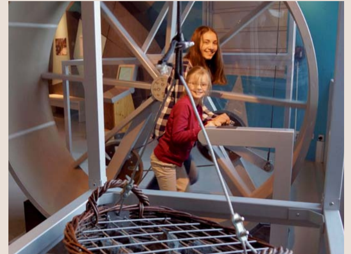
Mit dem Hamsterrad Energie erzeugen und Lasten bewegen
